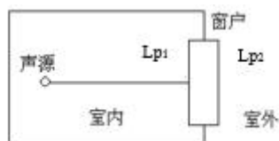
图 3 室内声源等效为室外声源图例
