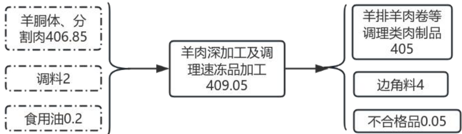
图 3.3-4 项目运营期物料平衡示意图-羊肉深加工生产线（单位：t/a）
